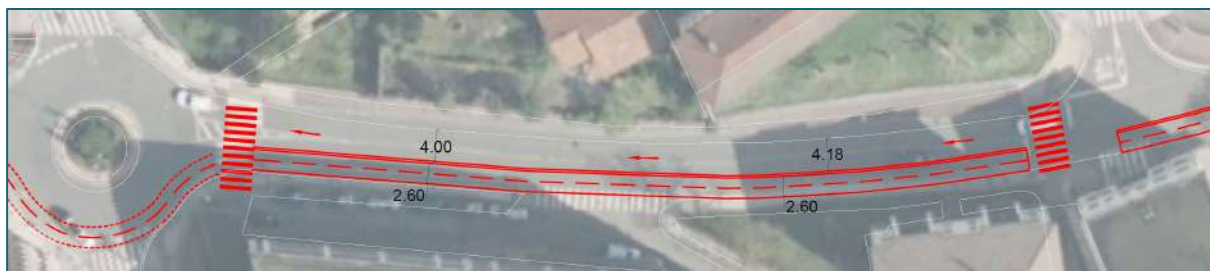
Figura 4.39. Gipuzkoa etorbideko tartean bidegorria implementatzeko proposamena, Maiatzaren 1a kalearekiko elkargunearen eta Lapurdi kalearekiko elkargunearen artean
