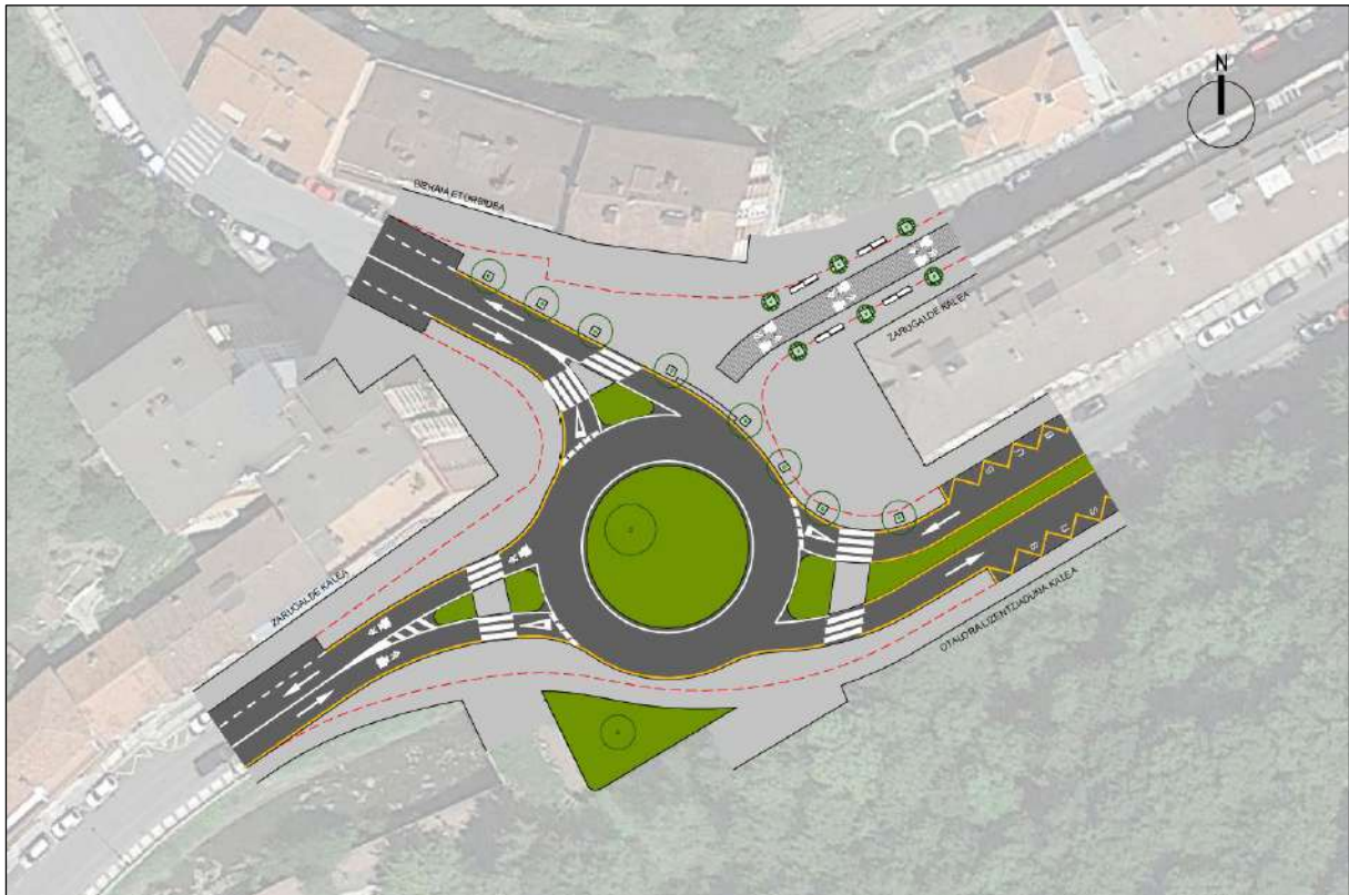
Figura 4.72. Detalle del plano 33, propuesta de remodelación del espacio en la rotonda entre las calles Otalora Lizentziatua, Zarugalde kalea y Bizkaia etorbidea
