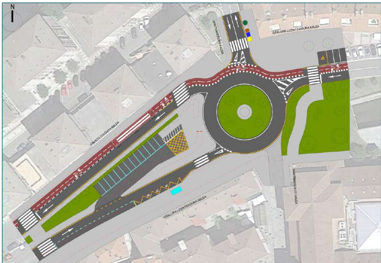
Figura 4.71. Detalle del plano 32, propuesta de remodelación del espacio en la rotonda entre las calles Otalora Lizentziatua.
